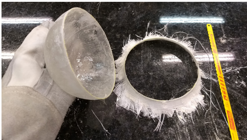
Figura 32 Peça começa a tomar forma com camadas de fibra e resina
