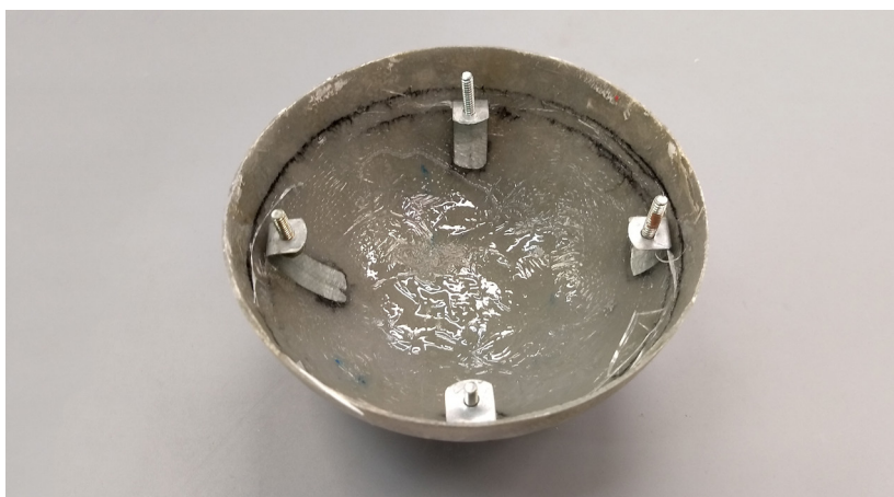
Figura 38 Após cura da resina, a guia de MDF pode ser retirada
