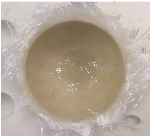
Figura 32 Peça começa a tomar forma com camadas de fibra e resina
